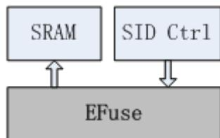
图 2-1: 带有 SRAM 的 SID 模块硬件结构
